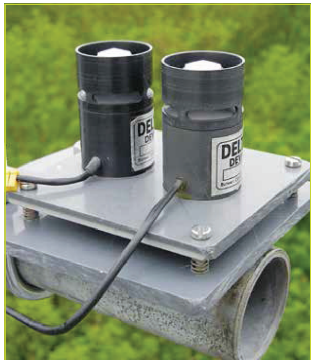
De PAR-sensoren bovenop de meetoren meten de hoeveelheid fotosynthetisch actieve straling (PAR), het spectrum van het zichtbare licht dat planten kunnen gebruiken om aan fotosynthese te doen.
