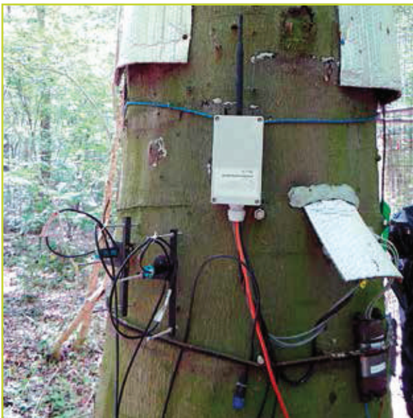
dendrometers (links op de stam) en een sapstroommeter (rechts op de stam, onder het isolerend afdakje) op de beuk naast de meetoren
